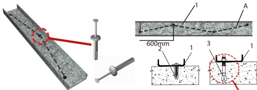
A. Los puntos de anclaje deberán de colocarse siempre en forma de zig zag a lo largo de todo el perfil canal.
