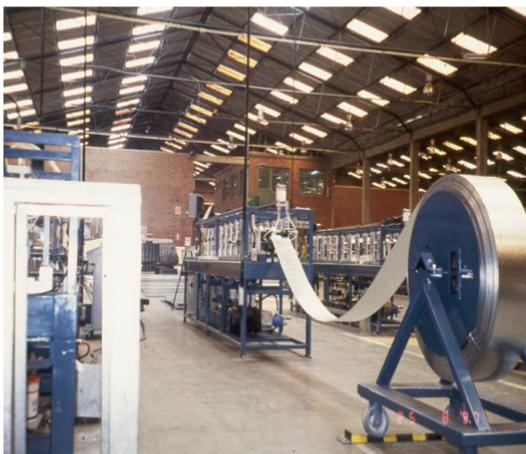
Con las bobinas cortadas longitudinalmente según los anchos de perfil, se insertan las cintas y por proceso de formado en frío se fabrica el perfil.
